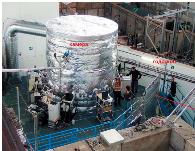
Рис.4. Общий вид экспериментальной установки CLOUD. Пучок заряженных пионов от ускорителя (красная стрелка) проходит через детекторы (годоскоп, состоящий из сцинтилляционных счетчиков), которые дают картину пространственного распределения частиц. Затем они попадают в камеру объемом 26 м 3 и ионизируют воздух. Снаружи и внутри камеры находится регистрирующая аппаратура и системы контроля.
